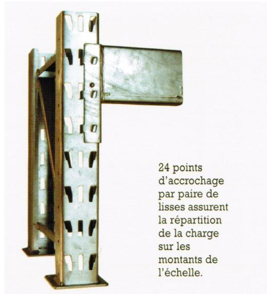
24 points d'accrochage par paire de lisses assurent la répartition de la charge sur les montants de l'échelle.
